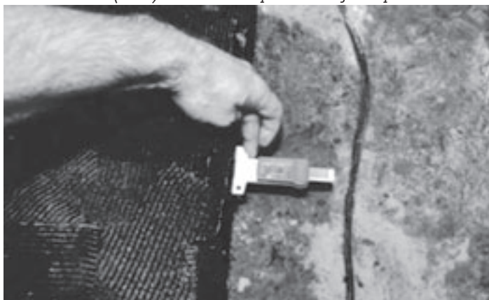
Bild 7 (oben): Schichtdickenmessung an Sohleüberstand.
