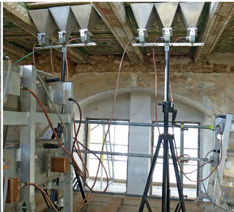
Herrenhaus, Obergeschoss, Aufbau der Mikrowellentechnik im Einsatz an zwei Deckenfeldern.
