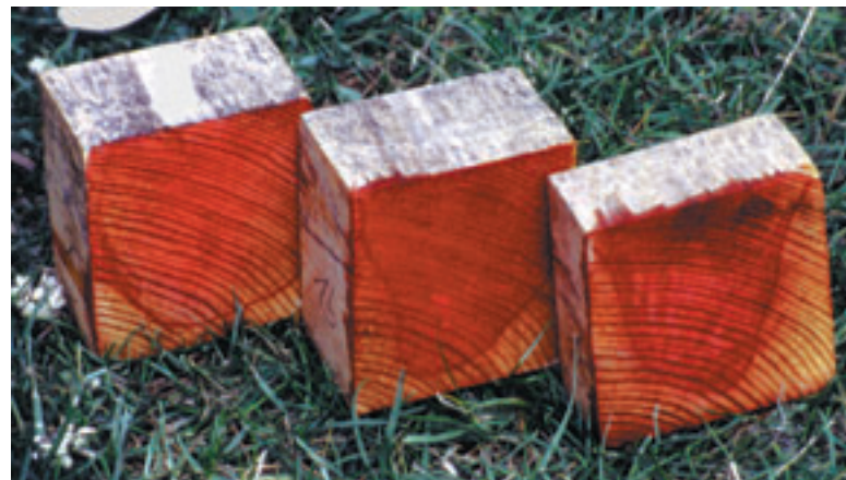
Bild 1: Borverteilung aus Impel-Bordübeln bei einer Lagerung in 90% Luftfeuchte über 6 Wochen: Bor durch Curcumin rot angefärbt. Links Eiche, Mitte Fichte, rechts Kiefer. Auffällig sind die sehr unterschiedlichen Verteilungsmuster, je nach Feuchteaufnahme der Holzarten. Während Kiefer eine deutliche ellipsoide Verteilung in axialer Richtung zeigt, ist bei Eiche bereits nach 2 cm axial kein Bor im trockenen Holz diffundiert. Dafür zeigt aber die gesamte Oberfläche bei Eiche und Fichte, auch auf der der Bohrer abgewandten Seite eine Diffusion von Bor! (Maße: Eiche 15 x 15 cm, Kiefer 8 x 16 cm.)
