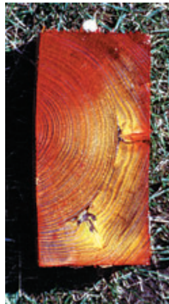
Bild 1: Borverteilung aus Impel-Bordübeln bei einer Lagerung in 90% Luftfeuchte über 6 Wochen: Bor durch Curcumin rot angefärbt. Links Eiche, Mitte Fichte, rechts Kiefer. Auffällig sind die sehr unterschiedlichen Verteilungsmuster, je nach Feuchteaufnahme der Holzarten. Während Kiefer eine deutliche ellipsoide Verteilung in axialer Richtung zeigt, ist bei Eiche bereits nach 2 cm axial kein Bor im trockenen Holz diffundiert. Dafür zeigt aber die gesamte Oberfläche bei Eiche und Fichte, auch auf der der Bohrer abgewandten Seite eine Diffusion von Bor! (Maße: Eiche 15 x 15 cm, Kiefer 8 x 16 cm.)
