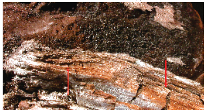
Abb. 9. Der Rosaporige Baumschwamm verursacht eine Braunfäule mit Würfelbruch (↑↓).
