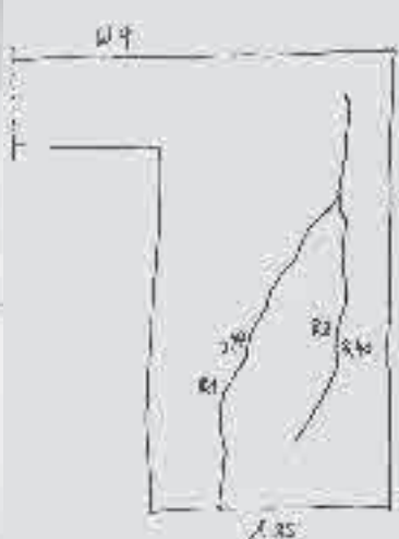
Links: Vorgefundenes Schadensbild (Risse). Oben: Grafische Darstellung der Risse. Rechts: Riss freigelegt (Putz abgeschlagen).
