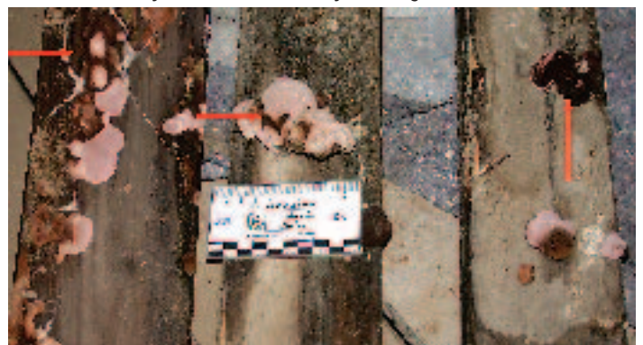
Abb. 7. Rosaporiger Baumschwamm ( F. rosea ): Die Fruchtkörper erinnern an den Rosafarbenen Saftporling ( Oligoporus placenta ), auffällig ist jedoch die schwarze Oberseite (→↑); Verwechslungen sind auch mit anderen Hausfäulepilzen möglich.
