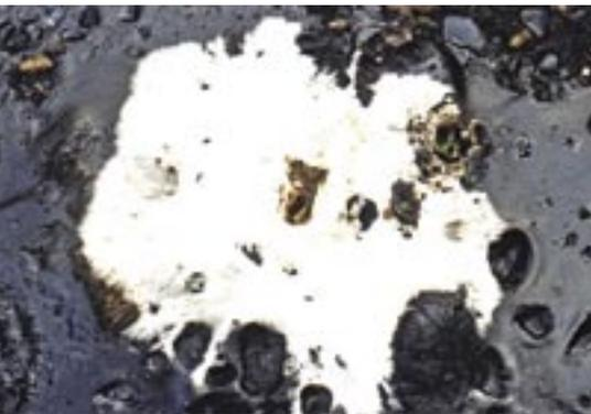
Links, Abb. 2: Weißes Mycel durchdringt den Raum zwischen Teerpappe und Nagel. Selbst kleinste Ritzen werden auf der „Suche“ nach Nährstoffquellen durchwachsen.
